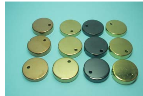
Obr.1.: Powlakované vzorky vrstvami zleva TiCN, TiN, TiAlN a ZrN.
