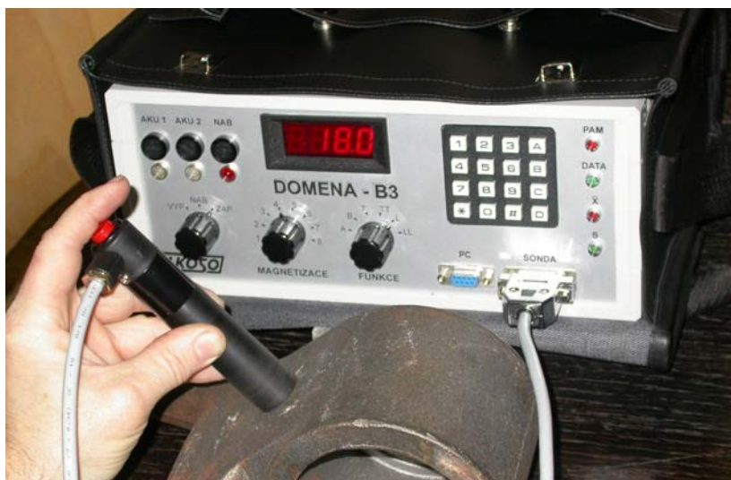
Obr. 1: Český přístroj DOMENA B3 při měření tvrdosti bezpečnostního odlitku z LKG.
